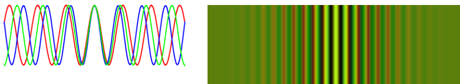
Рис. 3.7. Случай непрерывного спектра источников: а ) распределение интенсивности для разных компонент спектра по экрану; б ) интерференционная картина; в ) распределение полной интенсивности.
